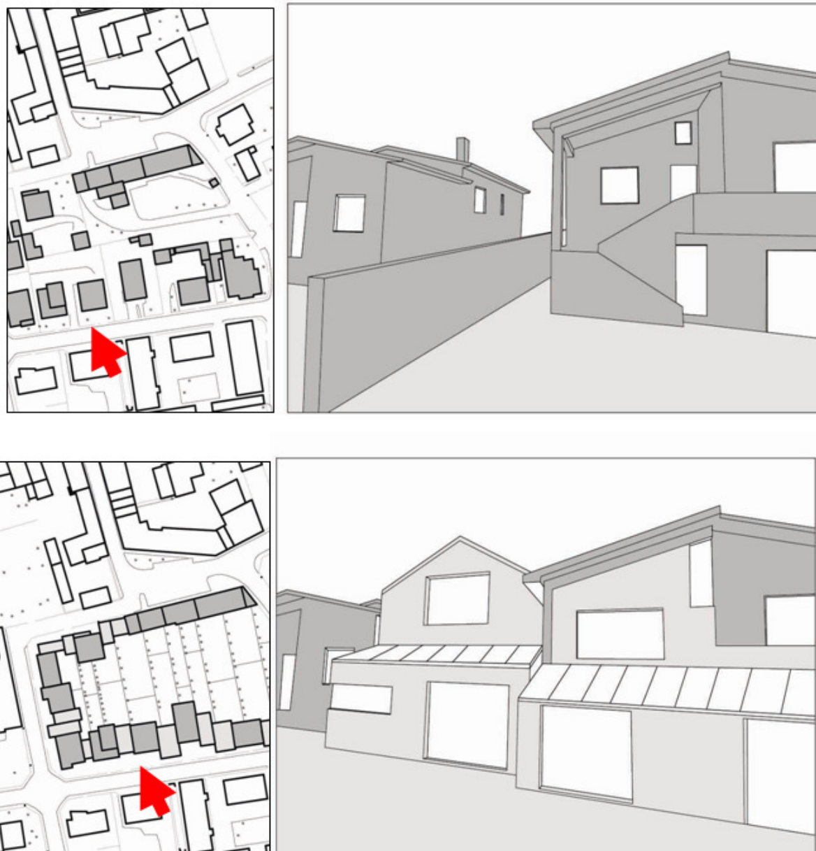
Fig. 4. Piante di inquadramento e viste prospettiche dell'edificio oggetto dell'applicazione, in alto prima dell'intervento di ampliamento, in basso dopo l'intervento (gli impianti eliotermici e fotovoltaici sono installate sulla copertura della parte più aggettante del piano terra).
