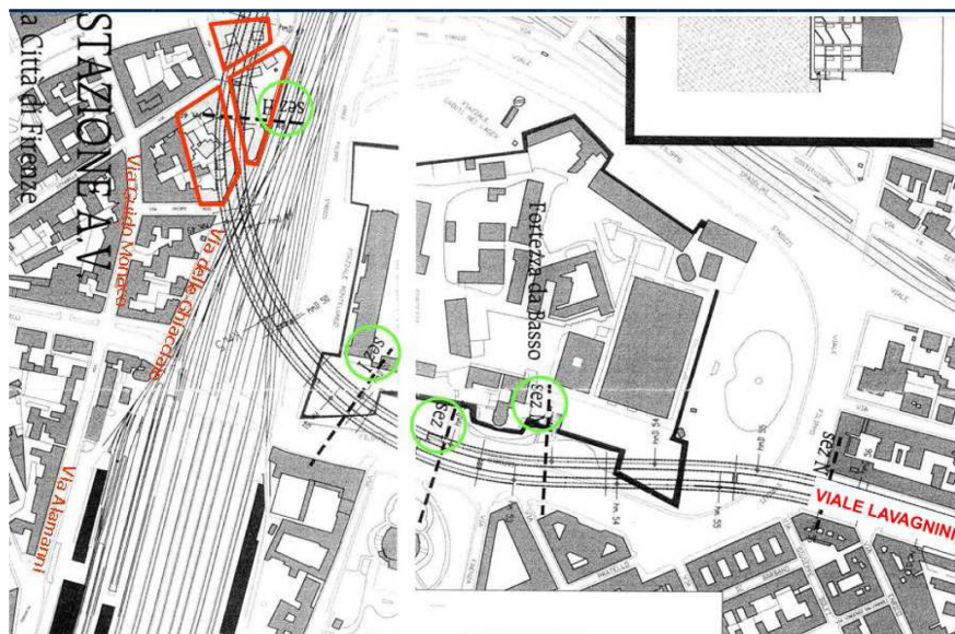
Figura 1. I due tunnel TAV sotto la Fortezza da Basso
